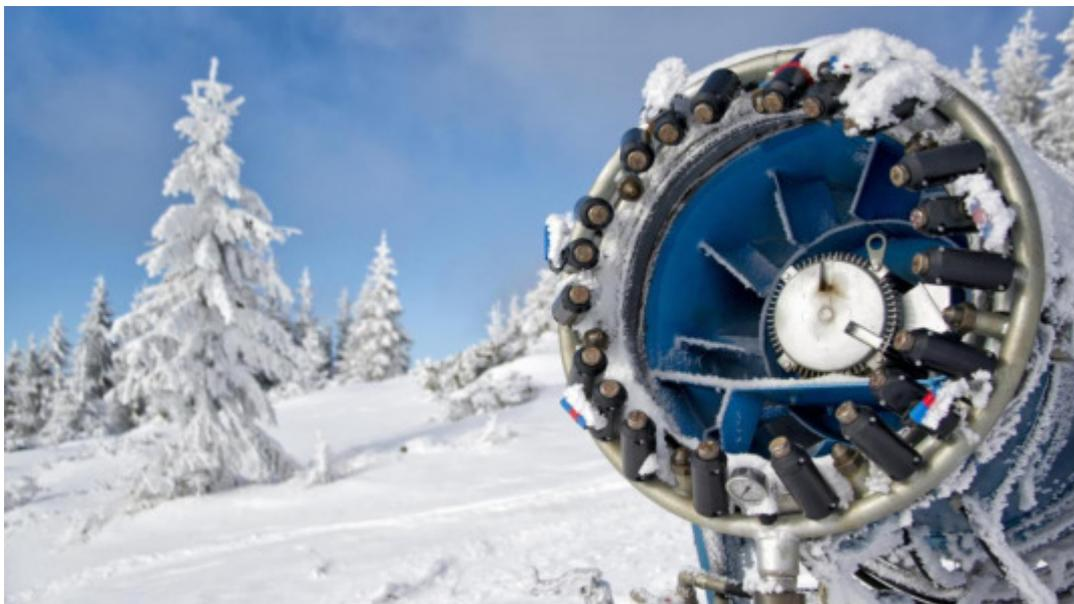
Abb. 16: Propeller (hellblau) erzeugt den Luftstrom, etliche Düsen (schwarz) blasen die Eiskristalle in die Öffnung
